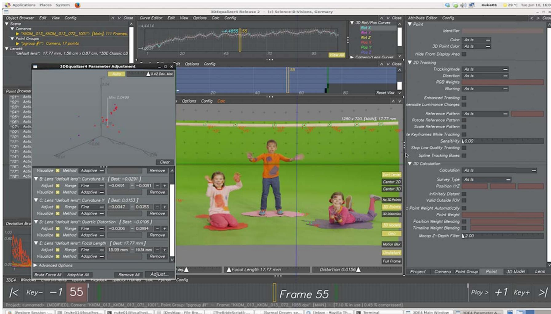
Abb. 7: Track8: Setzen der 'Groundplane' der Operator wählt Punkte auf dem Fußboden aus, damit das Programm die Position der Kamera im Raum kennt.
